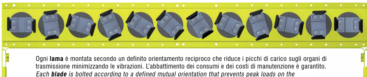
POSIZIONE DEI COLTELLI BLADE POSITION
